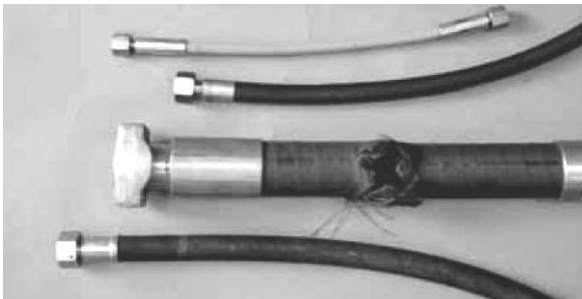
Conexiones flexibles defectuosas, utilizadas en la industria hidráulica.
